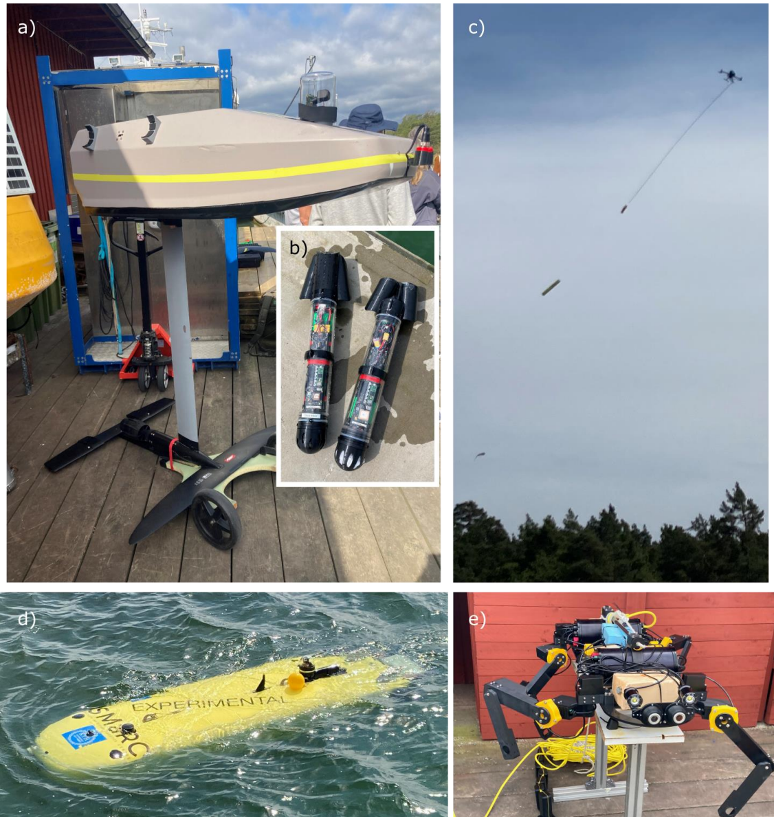
Figur 5. Bilder från SMaRC 2.0 Demo Day i juni 2025. a) Autonomous foilboard EVOLO, b) Swarming dive robot Puffin, c) upphämtning av undervattensfarkost (attrapp) med flygande drönare, d) Long-range and Long-endurance demonstrator (LoLo), e) Sea Iguana. Foto: Mathias Andersson, FOI.
